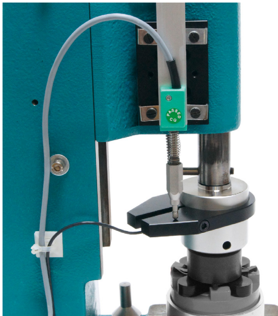
Système de mesure de déplacement (SMD) en position basse
