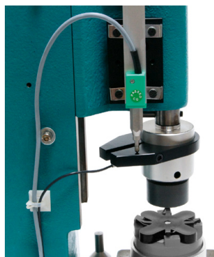
Système de mesure de déplacement (SMD) en position haute
