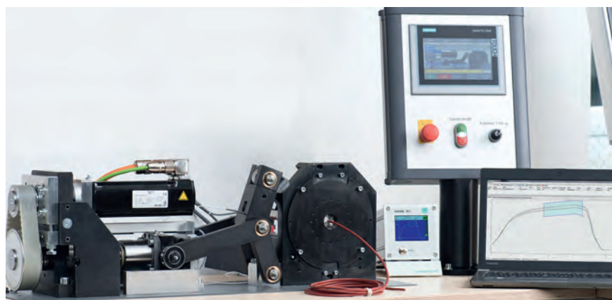
Eine Formpressmaschine für das »Segment- und Rollierformen« von Fichter formtec mit angeschaltetem Prüfcontroller Digiforce 9311 von burster.
