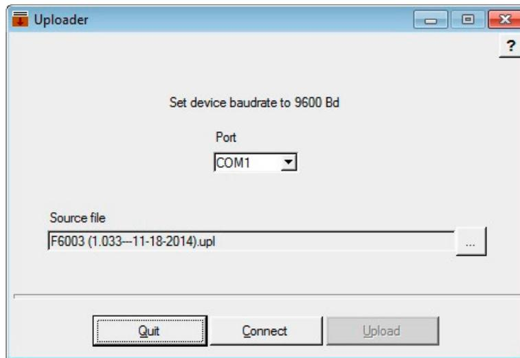
3. Wählen Sie die Quelldatei aus. Die Quelldatei ist eine Datendatei, welche die neue Firmware enthält und die Erweiterung ".upl" hat. Der Uploader wählt automatisch einen geeigneten COM-Port aus (COM1 ... COM32).
