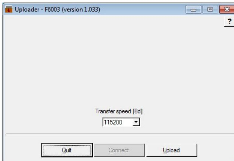
6. Drücken Sie "Hochladen" bzw. "Upload", ohne die Übertragungsgeschwindigkeit zu ändern.
