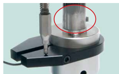
Stößel mit Innenbohrung und Madenschraube
